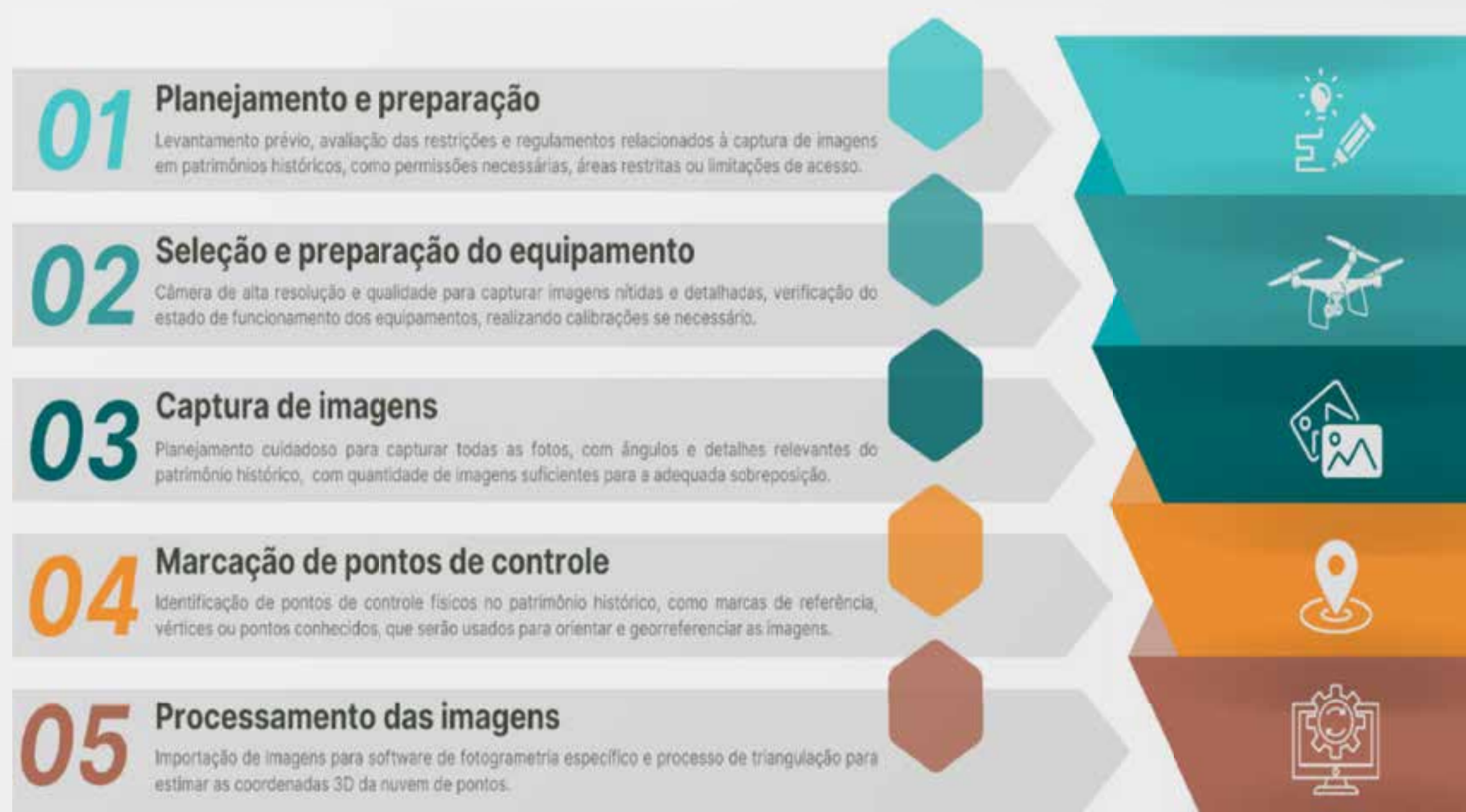
Figura 2: Planejamento e operação da fotogrametria Fonte: Autoral (2023)
