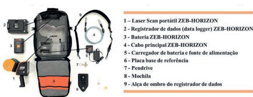
Figura 1 – Equipamento laser scanner completo com todos os componentes
