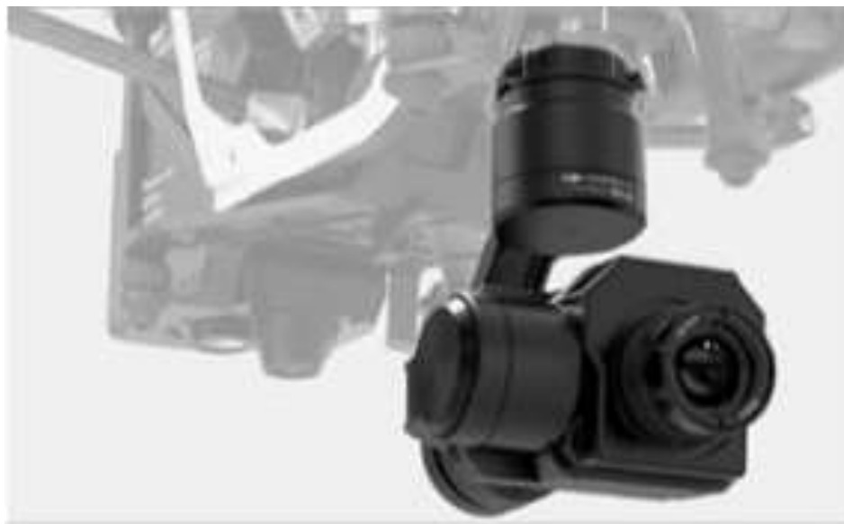
Imagem 20 - Drone Inspire com câmera termográfica acoplada.
