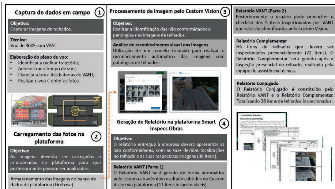
Figura 3 – Fluxo de atividades do Smart Inspects Obras – Inspeção de telhados
