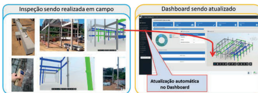
Figura 4. Gêmeo Digital correspondendo à montagem no canteiro de obra
