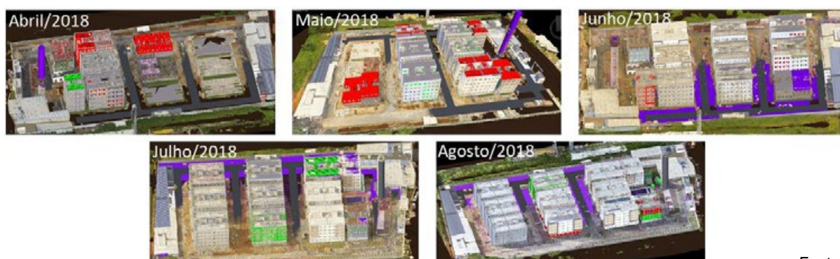
Figura 4: Modelos visuais sobrepostos (BIM 4D + nuvem de pontos) com código de cores para desvios de progresso na simulação 4D
