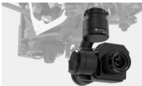
Figura 20 - Drone Inspire com câmera termográfica própria acoplada
