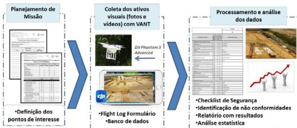
Figura 2: Protocolo de inspeção de segurança com VANT
