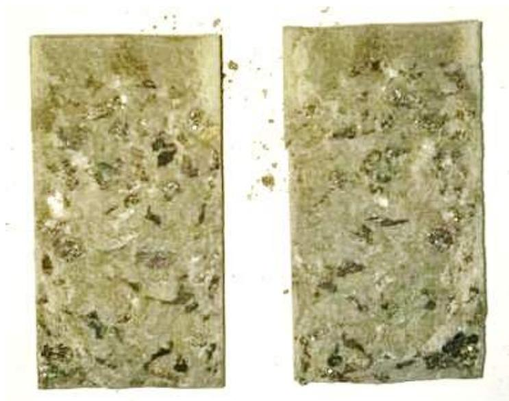
A partir da análise da imagem é possível constatar a homogeneidade do concreto lançado na forma metálica, observada a distribuição do agregado graúdo.
